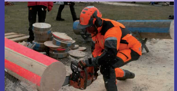
Hier wird die Schnittfolge an gespannten Bäumen simuliert. Eine der gefährlichsten Schnitttechniken in der Praxis.
